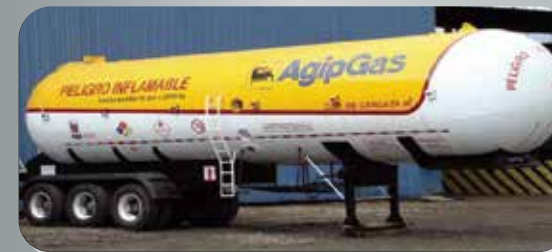
Autotank 54 m3 para GLP - AGIP
